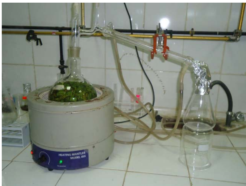
Fig.19. Dispositif d'extraction de l'HE à l'échelle de laboratoire. Laboratoire CRD de SAIDAL d'El Harrach. (Original, 2013)
