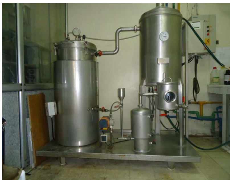
Fig. 21. Dispositif d'extraction de l'HE à l'échelle pilote.
