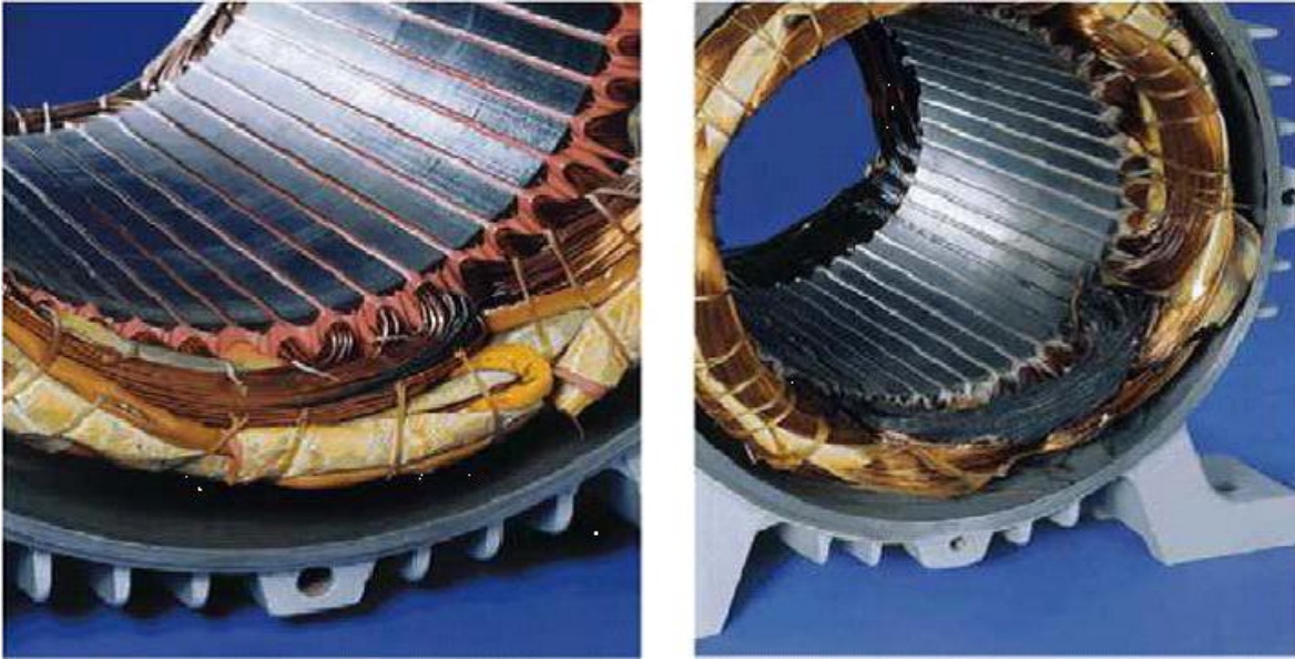
Figure 1.10: (a) Court-circuit entre spires de la même phase (b) Enroulement court-circuité
