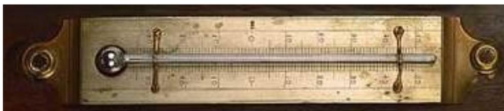
*Figure 1.3* : Thermomètre de Celsius.
