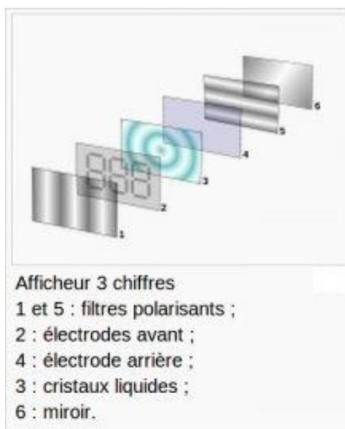
**Figure 3.24 :** Composition d'un écran LCD.
