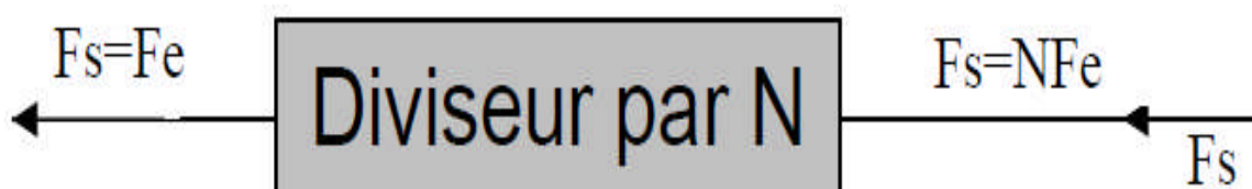
Figure 3. 18. Schéma fonctionnel d'un diviseur de fréquence
