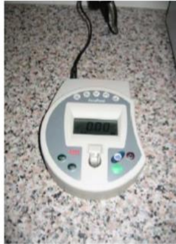
- Spectrophotomètre AccuRead® (Cliché issu de chez IMV technologies)
