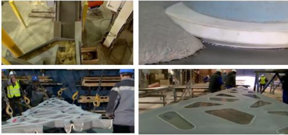
Figure 107: processus de réalisation de BFUP
