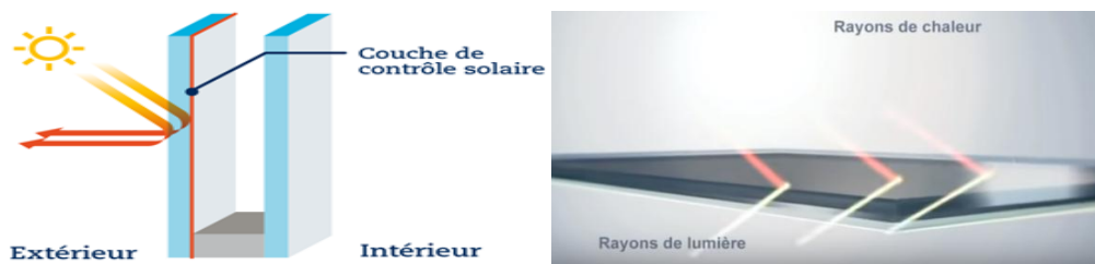
Figure 104 : verre à double vitrage
