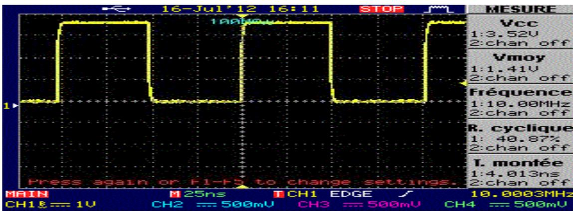
(c) Etablissement d'une horloge de 10 MHz
