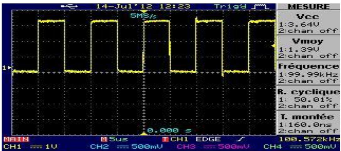
(c) Etablissement d'une horloge de 100 KHz
