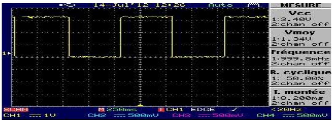
(b) Etablissement d'une horloge de 1 Hz
