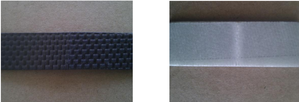
Figure III.8 : Zone de rupture de l'éprouvette de flexion.
