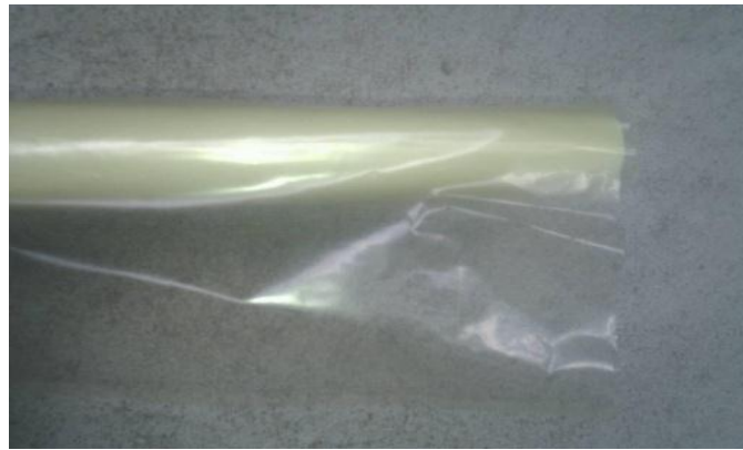
Figure II.5 : film de mise sous vide.
