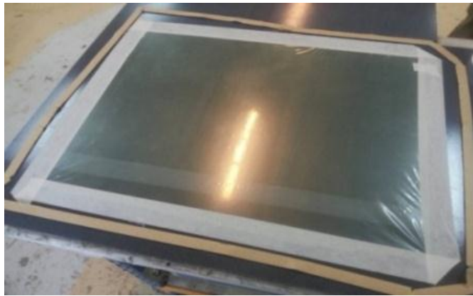
Figure II.10 : Dépôt du mastic d'étanchéité sur la périphérie de la surface du moulage.
