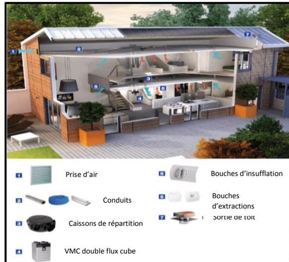
Figure 1.30: Composants de système de VMC double flux
