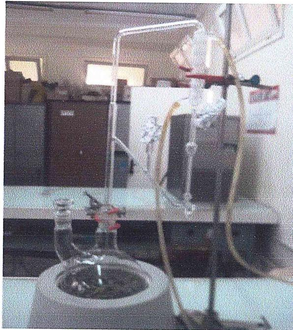
Figure 15 : montage de l'hydrodistillation « Clevenger »
