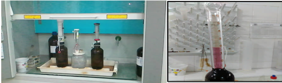
Figure 02 : Acide sulfurique et d'alcool iso-amyl Figure 03 : butyromètre de GERBER
