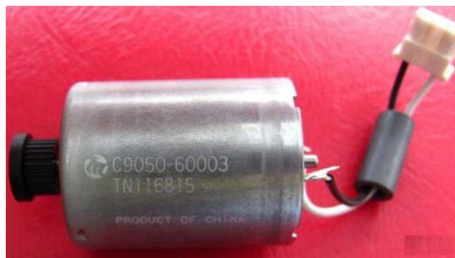
Figure 3.10 : Moteur à courant continu C9050-60003.
