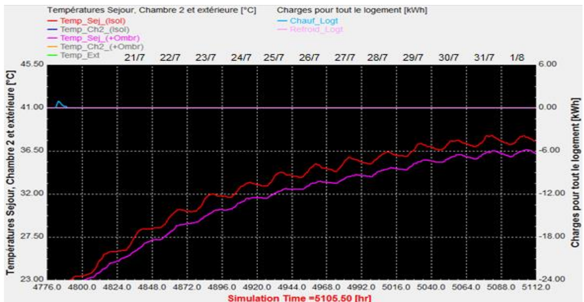
Fig. 3.13 – 19 juil. au 1 er août, Séjour avec ombrage et isolation (rose) et sans ombrage (rouge).
