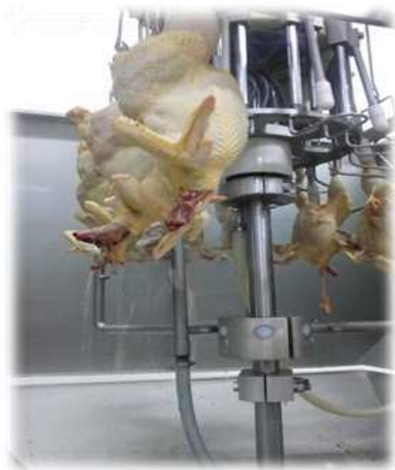
Figure n° 41 : lavage interne et externe
