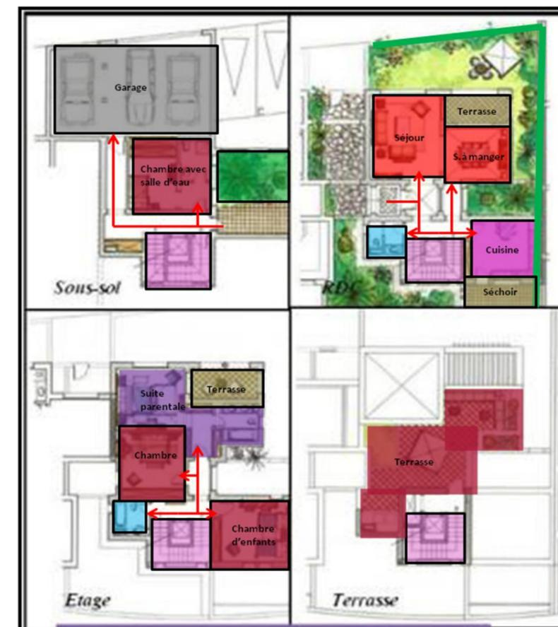
Figure 40 : analyse des plans des villas des quais (source : auteur)
