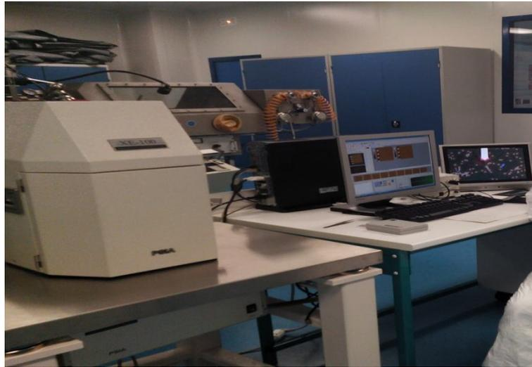
Figure IV.19 : Station AFM XE-100 utilisé pour la caractérisation des nanofils.
