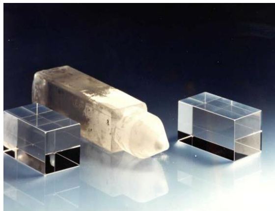
Figure 1.22 : Monocristaux de \text{BaF}_2 obtenus par méthode Bridgman.
