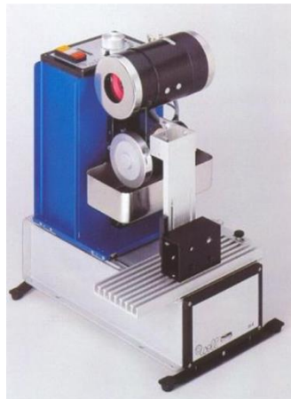
Figure 2.10 : Scie à fil diamanté
