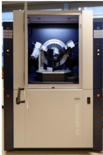
Figure 2.9 : Analyse de la phase et la pureté par un diffractomètre Bruker D8 Advance.
