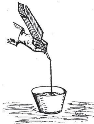
Figure 1.18 : Illustration représentant la première expérience de croissance par J. Czochralski en 1916.
