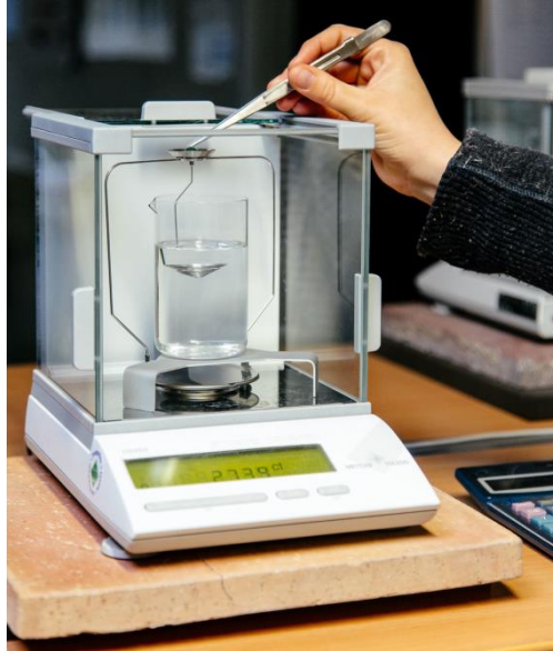
Figure 2.19 : Balance hydrostatique de mesure de masse volumique
