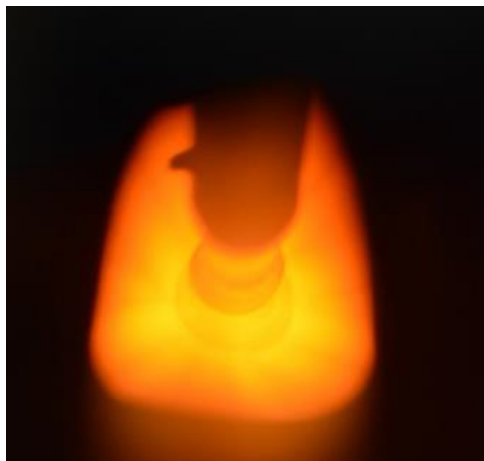
Figure 3.13 : Croissance cristalline stable du monocristal de LGT.
