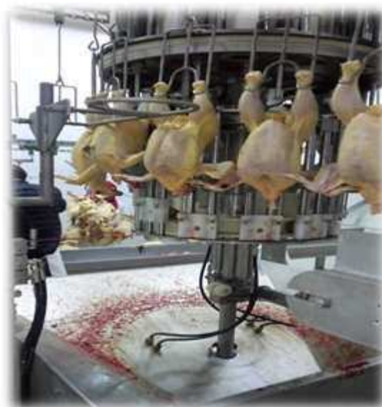
Figure n°24 : l'ouverture automatique des poulets
