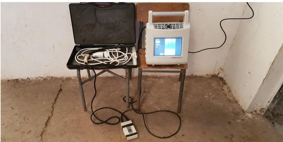
Figure 32 : Echographe ESAOTE PieMedical avec une sonde linéaire munie d'un tube de guidage.
