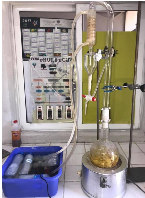
Figure 15 : Matériel d'hydro-distillation employé pour l'extraction de l'huile essentielle
