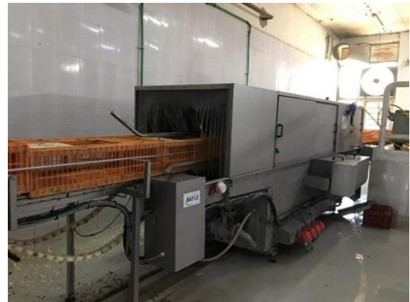
Photo 7 : Désinfection automatique des caisses vidées.
