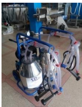
Figure 11 : Chariot trayeur à 2 faisceaux trayeurs
