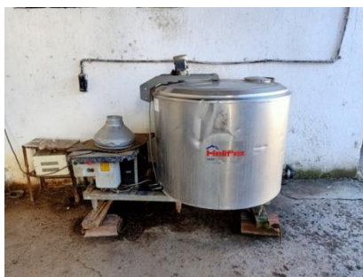
Figure 39 : Citerne réfrigérée de stockage du lait
