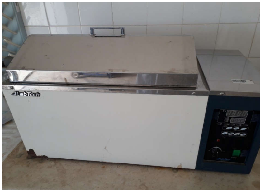
Figure 17 : Evaporation de la phase étheré dans un bain-marie
