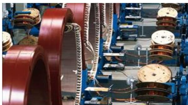
Figure 1.24: Chaîne de fabrication de générateurs d'éoliennes.
