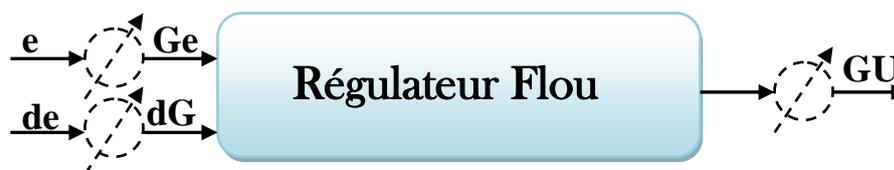
Figure 4.1: Schéma synoptique d'un contrôleur flou.
