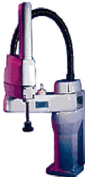
Fig 1.6 : Robot SCARA
