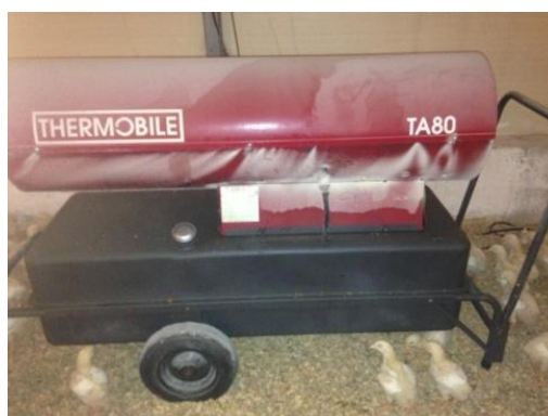
Figure 20 : Chaudière à gasoil thermobile
