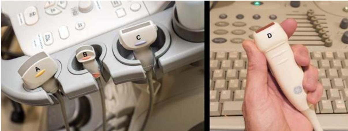
**Figure 12:** Sondes échographiques avec fréquences variables [45]. A : Sonde macro-convexe basse fréquence (3-8MHz) ; B : sonde micro-convexe avec fréquences plus hautes et surface de contact plus petite ; C sonde linéaire haute fréquence (10-18MHz) ; D-sonde cardiaque avec une petite surface de contact aplatie.
