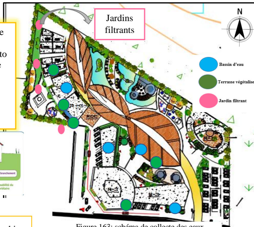
Figure 163: schéma de collecte des eaux Source : auteures
