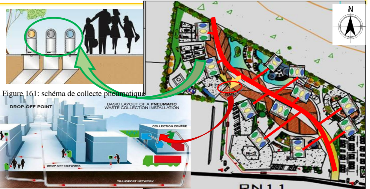
Figure 164:schéma de traitement des déchets du site Source : auteures
