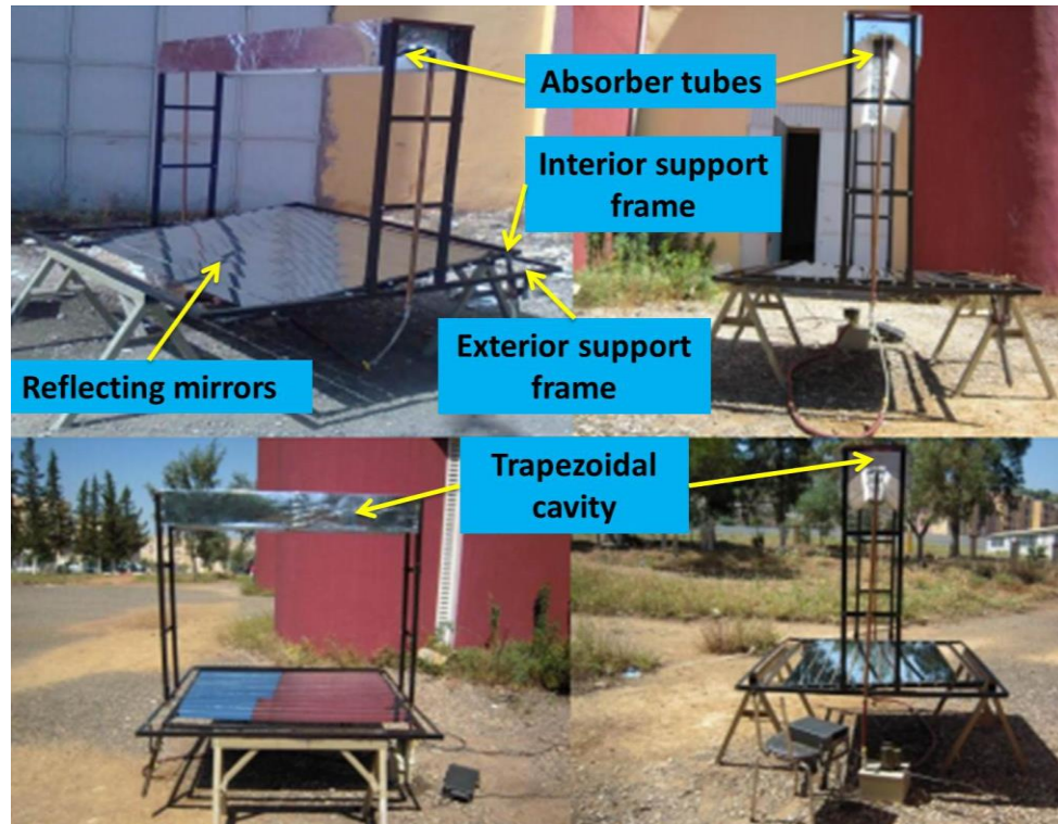
Figure 2. 20: La photo du dispositif expérimental.
