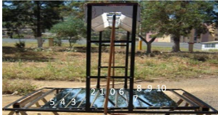
Figure 2. 25 : La configuration des miroirs à 12:00.
